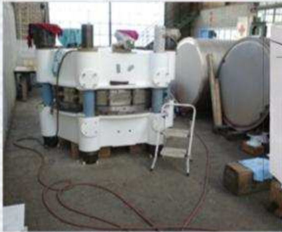
Electrolizador Alcalino Producción: 10 Nm 3 H 2 /h Pureza: 99.8 a 99.9% vol. Consumos: Energía 4.3 a 4.6 kWh/Nm 3 Agua 0.85 l/Nm 3 H 2 Refrigerante (H 2 O) 40 l/Nm 3 H 2
