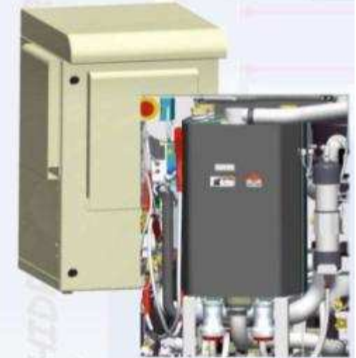
Pila de combustible Producción: 5kW Temperaturas de op.: -40°C a 46°C Consumo: 64 NI/min a 5 kW Presión de alimentación: 5.5 bar Pureza req.: 99.99% vol.
