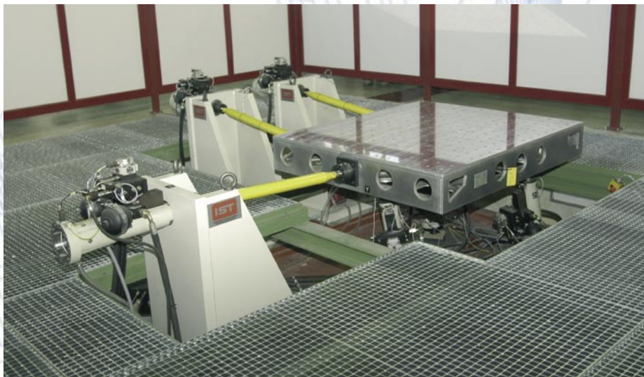
Sistema MAST (Multi-Axis Shaking Table) del Instituto Tecnológico de Aragón (ITA).
